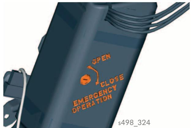
Vis de commande de secours et indication du sens d'actionnement sur le boîtier de la pompe hydraulique de commande de la capote.
