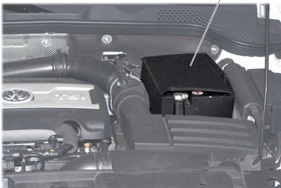
АКБ в моторном отсеке с теплозащитным кожухом
