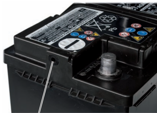
Отверстие центрального газоотвода
