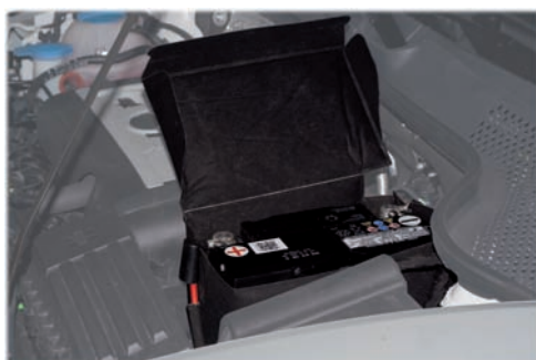
Теплоизолирующий кожух с крышкой
