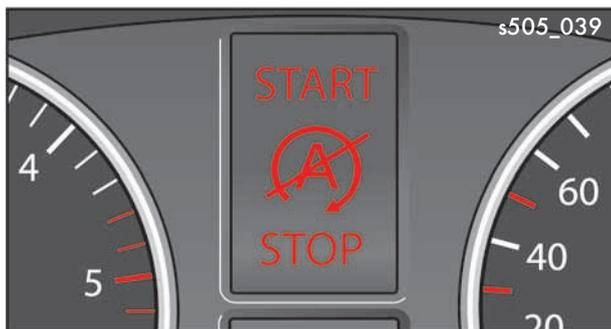
Индикация отключенной системы Старт-стоп в комбинации приборов Highline
