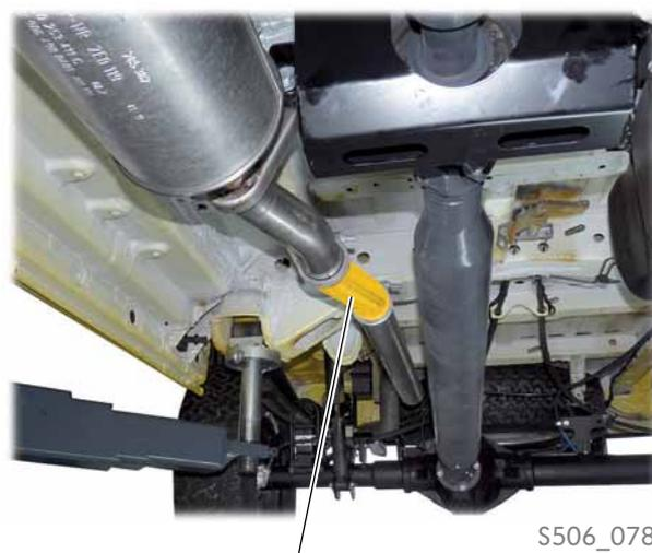
Tube de désalignement arrière sur l'embout d'échappement
