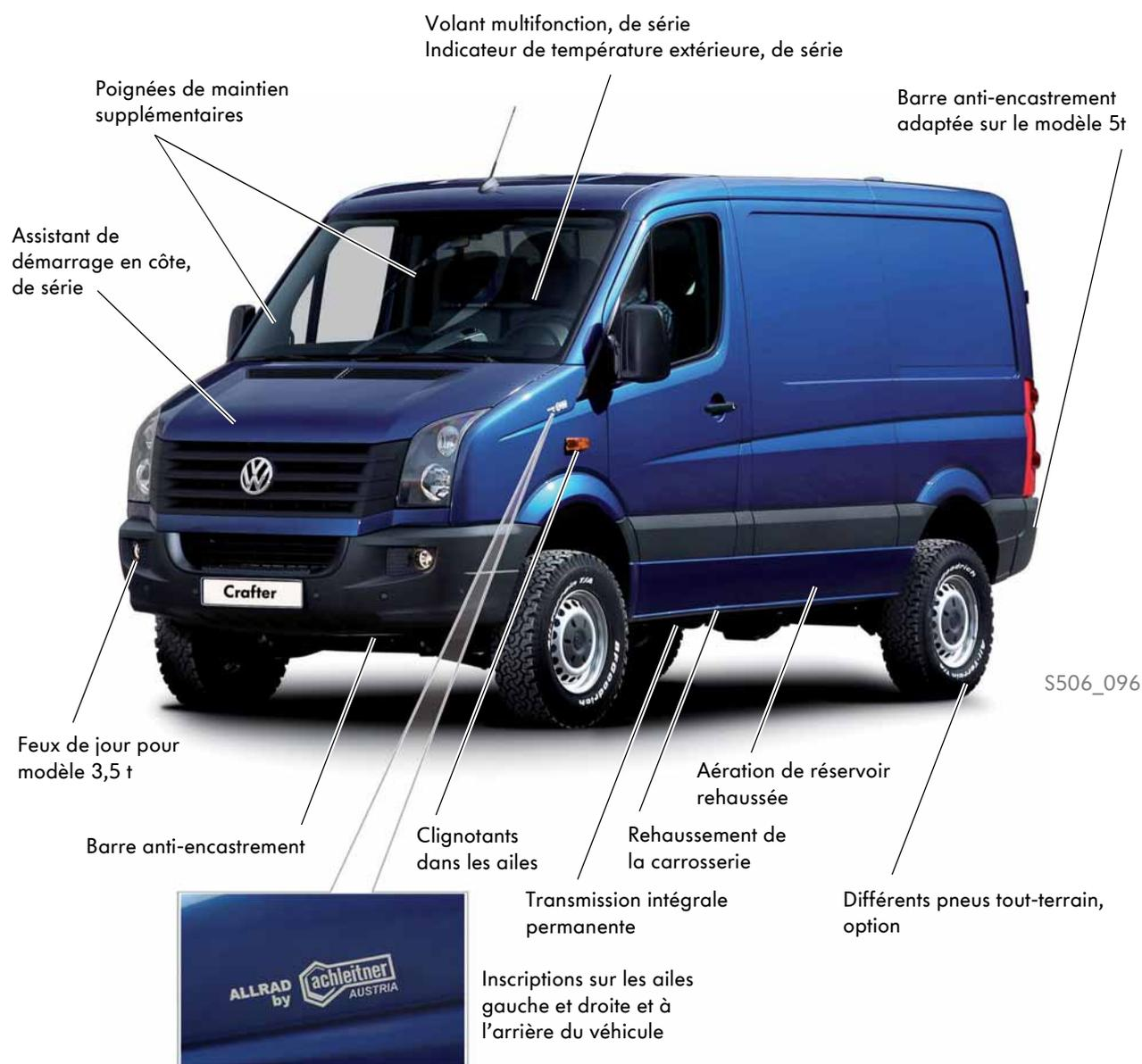
La pose de la transmission intégrale ne requiert aucune adaptation supplémentaire au niveau de la carrosserie. La fixation des essieux de la suspension s'effectue au niveau des points de fixation connus du Crafter 4x2.
