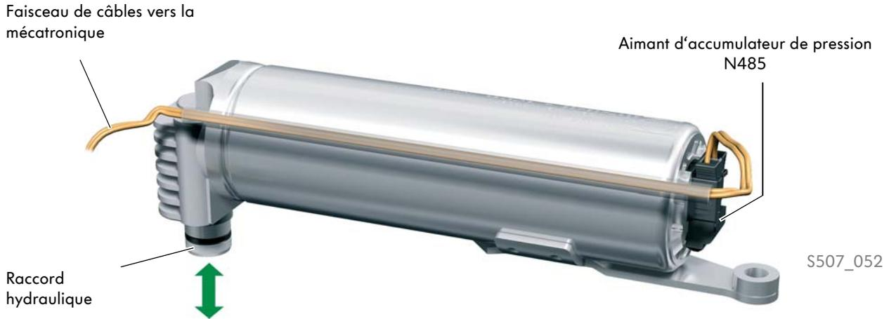
L'accumulateur à impulsions hydraulique dispose d'un volume utile d'environ 100 cm<sup>3</sup>.
