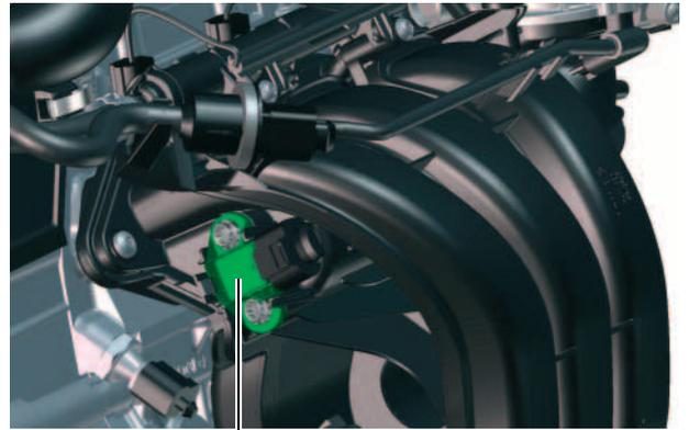
Transmetteur de pression de tubulure d'admission G71 avec transmetteur de température de l'air d'admission G42
