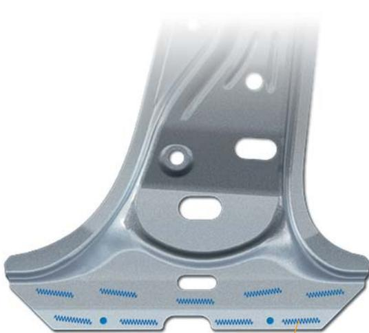
Cordon de soudure sinusoïdal
