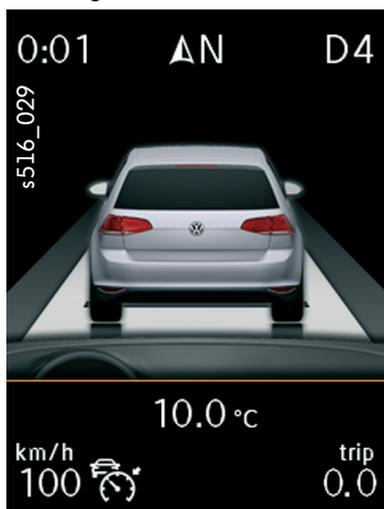
Conduite derrière un véhicule – distance réelle courte, distance assignée longue
