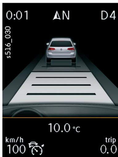
Conduite derrière un véhicule – distance réelle longue, distance assignée longue (écart 4)
