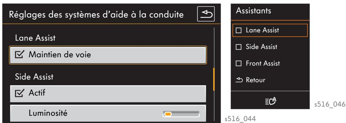
L'assistant de maintien de voie peut être activé via le menu de l'indicateur multifonction. La fonction supplémentaire de maintien de voie peut quant à elle être activée via le menu de l'assistant de maintien de voie sur l'unité de commande du système d'infodivertissement.
