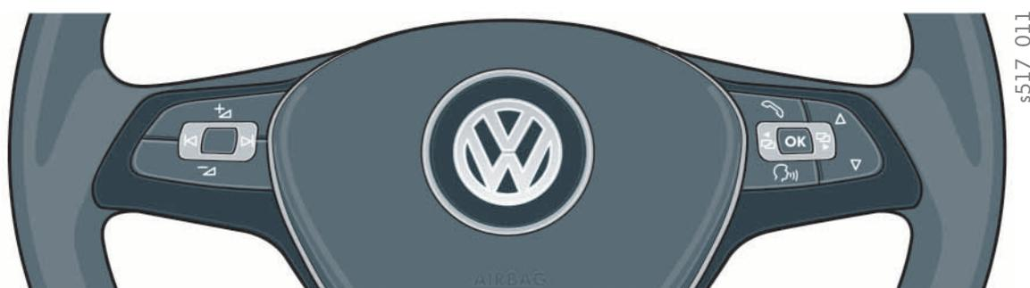
Sur la branche gauche du volant se trouvent les touches de commande de sortie audio, avec les fonctions suivantes :
