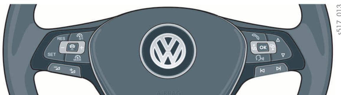
Sur la branche gauche du volant se trouvent les touches de commande du régulateur de vitesse et du régulateur de distance avec les fonctions suivantes :
