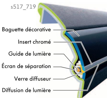
Un mince verre diffuseur en matière plastique transparente a été monté sous l'insert chromé de la baguette décorative. Derrière le verre diffuseur passe un guide de lumière alimenté par une DEL. Un écran de séparation de la lumière permet d'éviter qu'une lumière diffuse ne s'échappe par les interstices et autres plans de séparation inhérents à la conception du véhicule.
