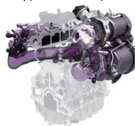
Recyclage des gaz d'échappement basse pression
