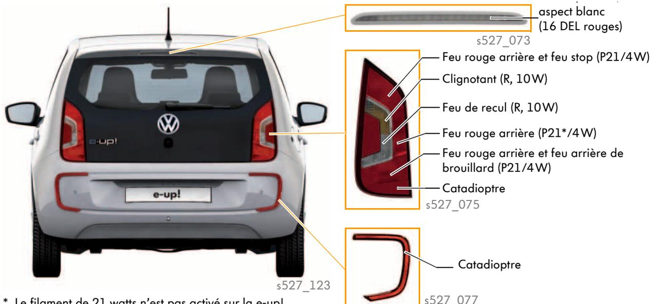
\* Le filament de 21 watts n'est pas activé sur la e-up!.
