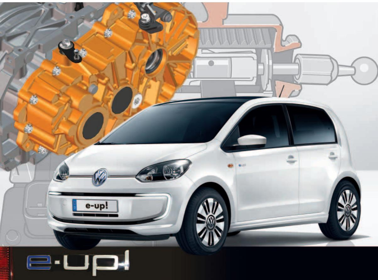
La e-up! est le premier véhicule électrique de Volkswagen produit en grande série. Elle est également la première voiture à être dotée du système de freinage assurant la récupération de l'énergie au freinage et de la boîte monovitesse 0CZ, cette dernière constituant une unité avec la transmission à courant triphasé. Le couple d'entrée maximal de la boîte monovitesse 0CZ est de 210Nm ; la boîte est silencieuse sur toute la plage de régimes.
