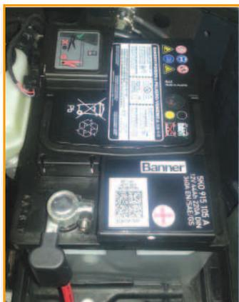
Batterie du réseau de bord 12 V
