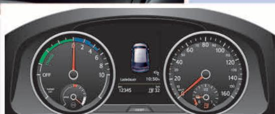
Combiné d'instruments avec indicateurs spécifiques à la propulsion électrique
