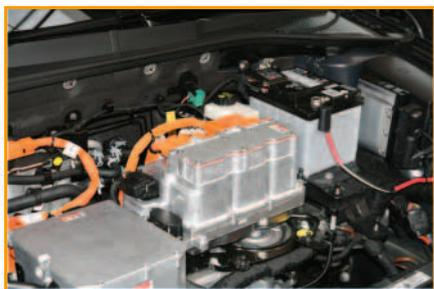
Électronique de puissance et de commande pour transmission électrique JX1
