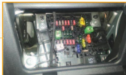
Boîtier de fusibles et calculateur de réseau de bord J519 dans l'habitacle, côté conducteur
