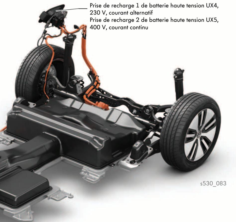
Prise de recharge 1 de batterie haute tension UX4,
