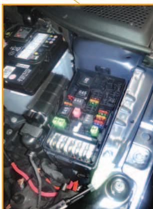
Boîte à fusibles dans le compartiment-moteur, devant la batterie du réseau de bord 12 V avec le fusible multiple (Multifuse)
