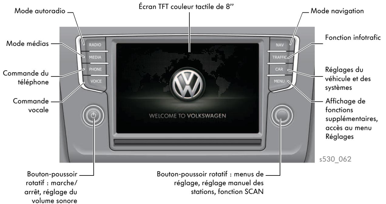
Le Discover Pro a été modifié en vue de son utilisation sur un véhicule électrique et dispose des fonctionnalités supplémentaires suivantes :
