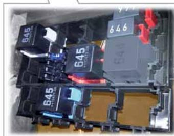
Calculateur de réseau de bord, derrière le porte-relais/fusibles à gauche dans le tableau de bord
