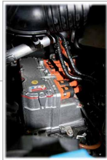
Au lieu d'un alternateur comme sur un véhicule doté d'un moteur à combustion interne classique, c'est l'électronique de puissance et de commande pour transmission électrique JX1 qui assure l'alimentation, le soutien et la recharge du réseau de bord 12 V du XL1.
