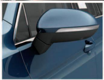
Rétroviseurs extérieurs implantés sur le rebord supérieur de porte
