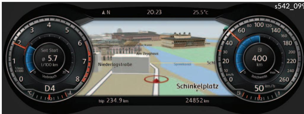
Sur le nouveau combiné d'instruments Active Info Display, les instruments analogiques sont pour la première fois reproduits sous forme purement numérique et intégrés dans l'afficheur global.
