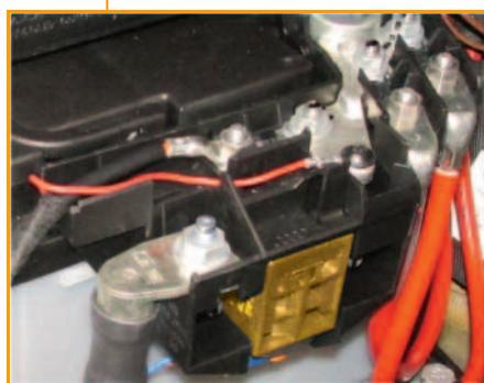
Boîtier de fusibles principal avec porte-fusibles SD, cosse de borne positive et commande de coupure de batterie J990
