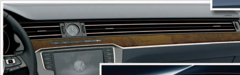
Bandeau diffuseur d'air horizontal dans le tableau de bord
