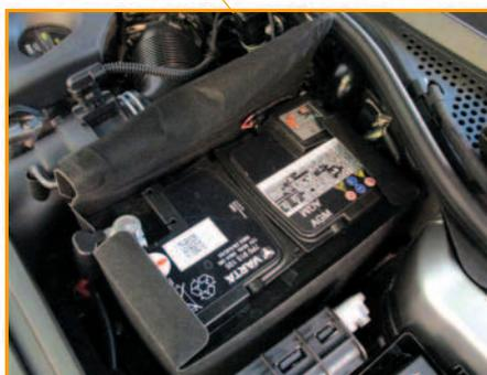
Batterie 12 V dans le compartiment-moteur
