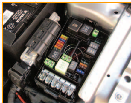
Boîtier électronique avec porte-relais et porte-fusibles SB et porte-fusibles primaire Multifuse SA
