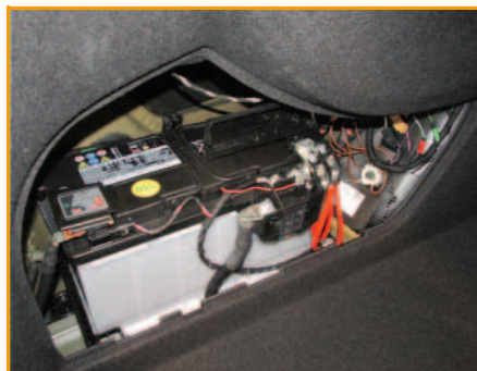
Batterie 12 V dans le coffre à bagages avec boîtier de fusibles principal
