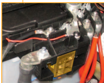
Boîtier de fusibles principal avec porte-fusibles SD, cosse de borne positive et commande de coupure de batterie J990
