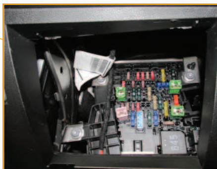
Porte-relais et porte-fusibles SC en bas à gauche dans l'habitacle, derrière le rangement
