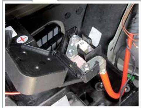
Fusible (200 A) sur le pôle positif de la batterie 12 V de bord
