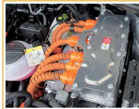
Boîtier de module électrique avec porte-relais et porte-fusibles SB et porte-fusibles primaire Multifuse SA
