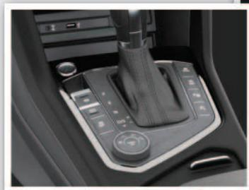
Bloc de commande pour sélection de profil de conduite (4MOTION Active Control)
