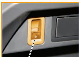
Touche pour dispositif d'attelage à pivotement électrique E474
