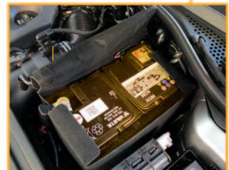
Batterie 12 V dans le compartiment-moteur
