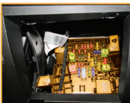
Platine porte-fusibles SC sur le porte-relais et porte-fusibles SR2
