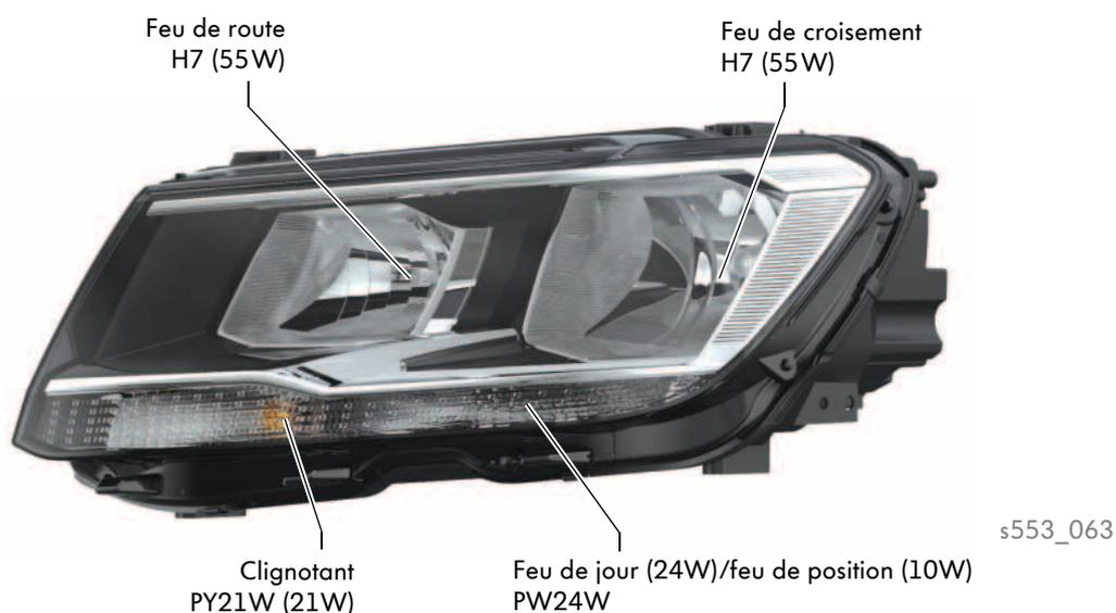
Les projecteurs halogènes sont dotés d'un dispositif manuel de réglage du site, qui peut être ajusté à l'aide d'un potentiomètre situé sur la commande rotative d'éclairage.
