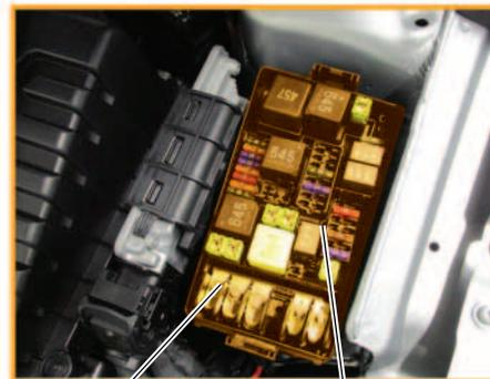
Platine porte-fusibles primaires Multifuse SA sur le porte-relais et porte-fusibles SR1
