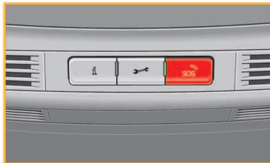
Les haut-parleurs du système d'infodivertissement sont utilisés pour l'appel d'urgence et l'appel de dépannage. En cas de défaillance du système d'infodivertissement (par ex. à la suite d'un accident), c'est le haut-parleur supplémentaire pour système télématique qui est utilisé. Il est relié directement au J949.
