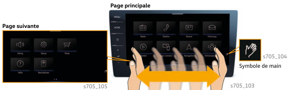
Quatre DEL infrarouges et deux photodiodes se trouvent sous l'écran tactile. Les DEL émettent une lumière dans le spectre infrarouge. Les photodiodes reçoivent la lumière réfléctée par les objets présents dans la zone de détection et affectent aux gestes des modifications du spectre infrarouge. Elles permettent ainsi de reconnaître les mouvements de la main et d'y attribuer un geste. Seuls les gestes horizontaux sont reconnus.
