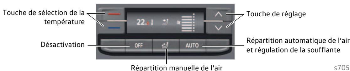
Si le véhicule dispose en plus d'un deuxième appareil de chauffage et de climatisation associé à un climatiseur automatique « Climatronic », l'unité de commande et d'affichage du climatiseur à l'arrière E265 est installée. Cette unité de commande à l'arrière permet de commander le deuxième appareil de chauffage et de climatisation depuis le compartiment passagers.
