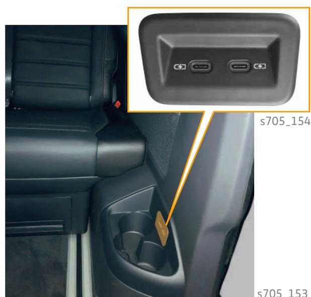
Les ports USB ne sont pas compatibles avec la norme « USB-Power Delivery ».
