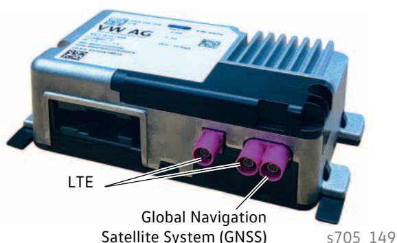
Sur le T6.1, la version OCU 3 Low est installée avec l'autoradio MIB2. Cette version ne dispose pas d'une connexion Ethernet.
